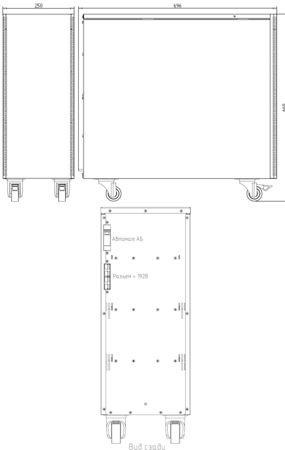
Рисунок 1 – Габаритные размеры и внешний вид изделия
