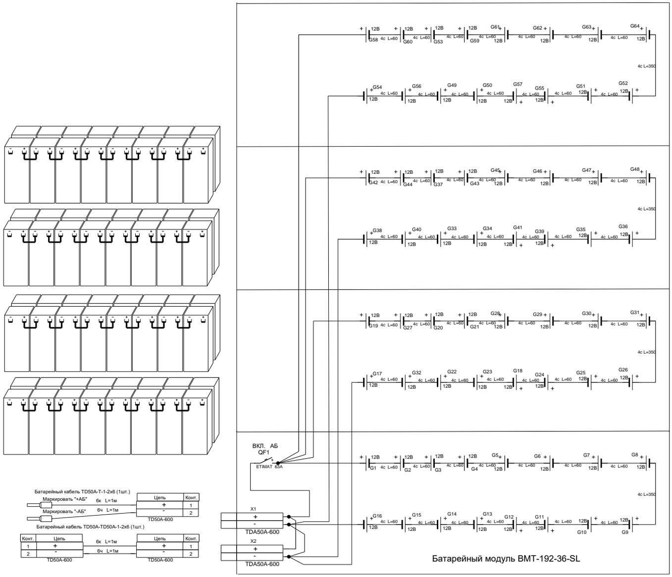
Рисунок 2 – Схема электрическая соединений
