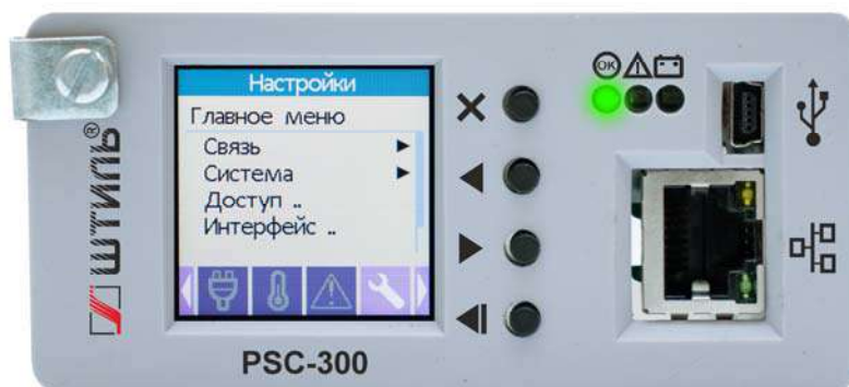
Рисунок 2.2 – Лицевая панель контроллера Штиль PSC-300
