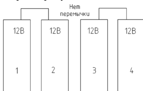
Рисунок 2.1 – Рекомендуемая конфигурация сборки АБ перед подключением
