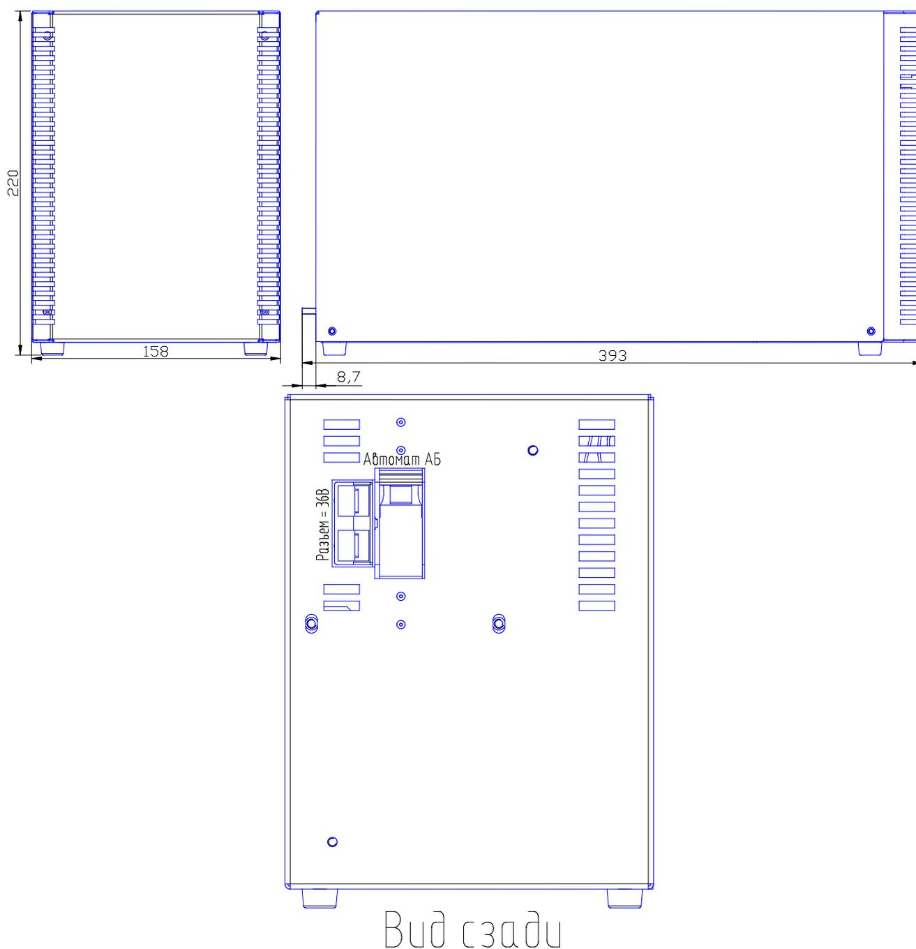
Рисунок 1 – Габаритные размеры и внешний вид изделия
