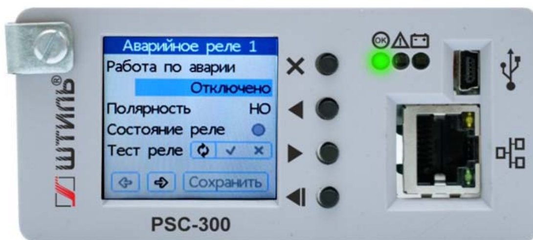
Рисунок А15 - Окно " Аварийное реле "
