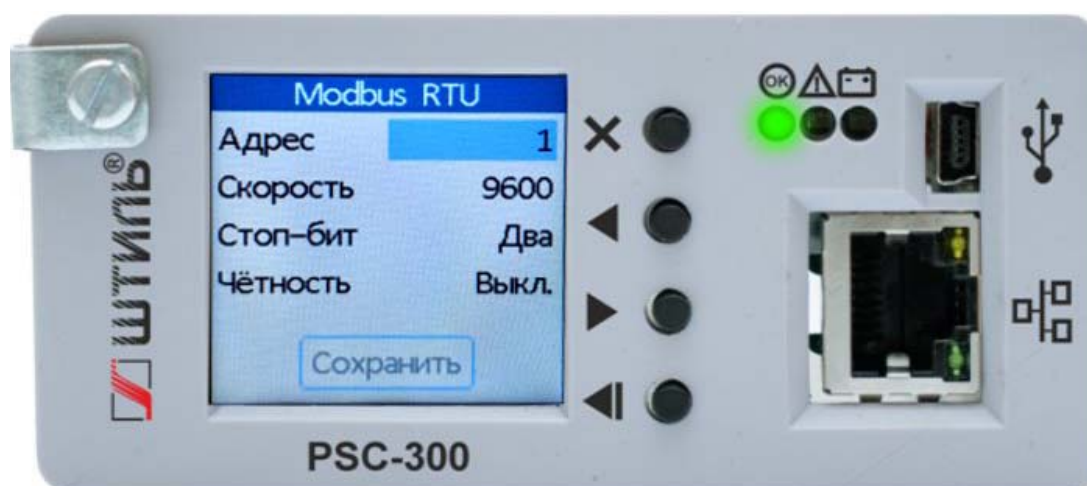
Рисунок А13 - Окно "Modbus RTU "
