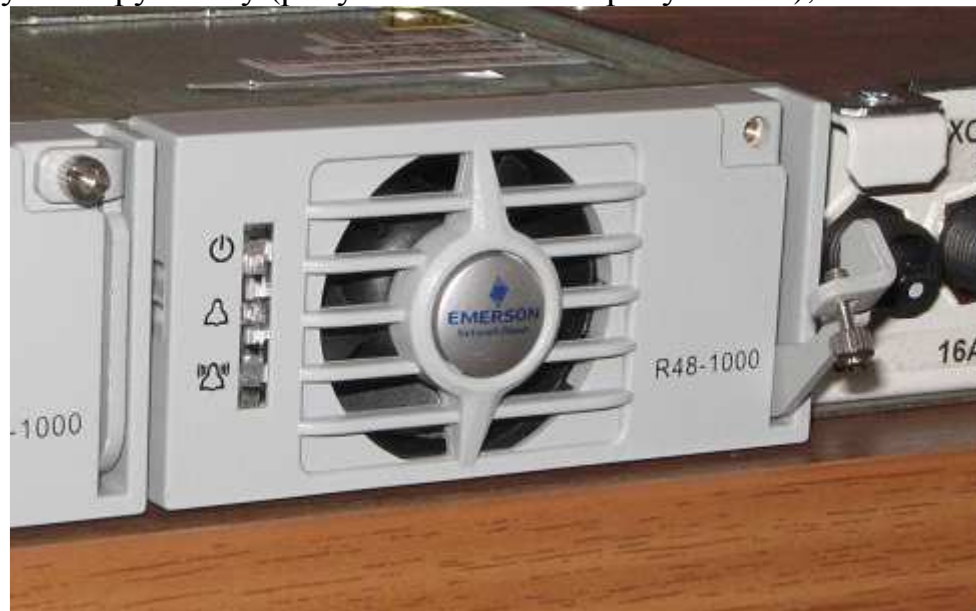
Рисунок 3.1 – Выпрямитель Emerson BML 440021/1
