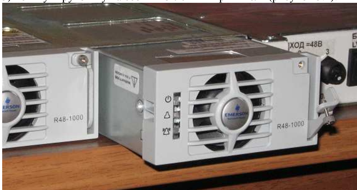
Рисунок 3.2 – Извлечение выпрямителя Emerson BML 440021/1
