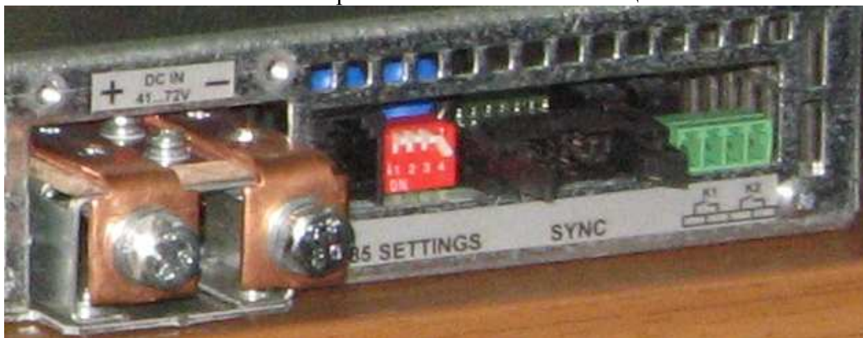
Рисунок 2.2 - Модульный каркас Штиль PS1000К. Тыльная сторона. Вид на дип-переключатель (Settings) настройки параллельной работы
